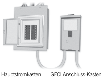
Hauptstromkasten GFCI Anschluss-Kasten
